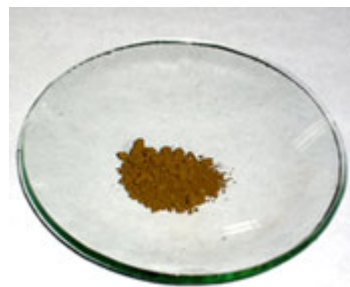
Catalizador que se utiliza en la reacción de oxidación preferencial de monóxido de carbono.
