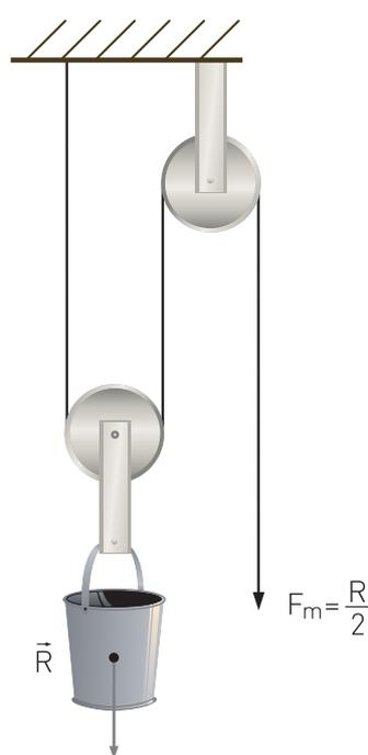
↑ Combinación de polea fija y polea móvil.
