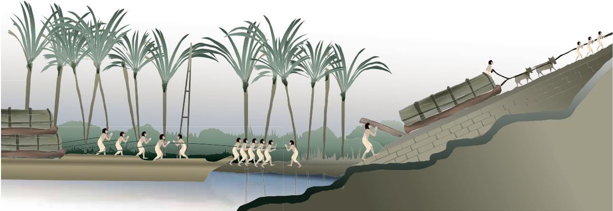
Se denomina plano inclinado a una superficie inclinada que forma un ángulo agudo con respecto a un plano horizontal. Este elemento es una de las llamadas **máquinas simples** porque **facilitan las tareas del hombre y permiten “ahorrar” esfuerzos** cuando por ejemplo se quiere subir un cuerpo, levantar objetos pesados, remover o cambiar una cosa de lugar, etc.
