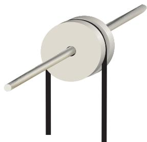
Junto con el plano inclinado, otro dispositivo ya utilizado y conocido en civilizaciones antiguas fue la polea simple. Una polea es un disco rígido que tiene una periferia acanalada (roldana), que puede girar alrededor de un eje y por donde pasa una cuerda, sogas o cadena.
